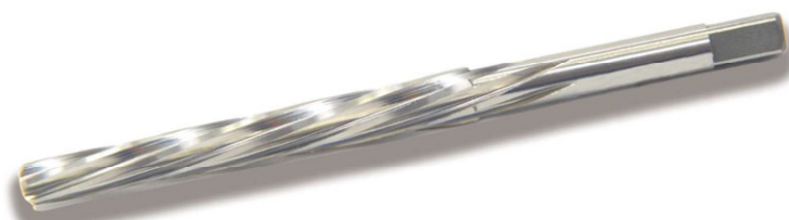
1/50テーパー 右刃左ネジレ12° 食付角度45° SKH51 1/50Taper Helix Angle-Left 12° Chamfer Angle45° HSS
