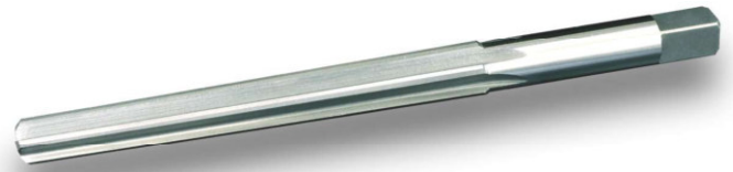
1/50テーパー 右刃ストレート 食付角度45° SKH51 1/50Taper Straight Flute Chamfer Angle45° HSS
