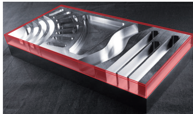
※外周(赤色)部の加工です。 The outer periphery machining (Red part).
